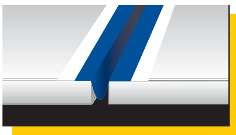
Posicionamento em ómega de Mapeband no interior da junta de dilatação
